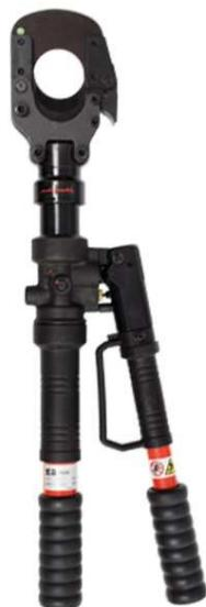
Určeny pro stříhání hliníkových, měděných a ocelových kabelů do průměru 50mm.
